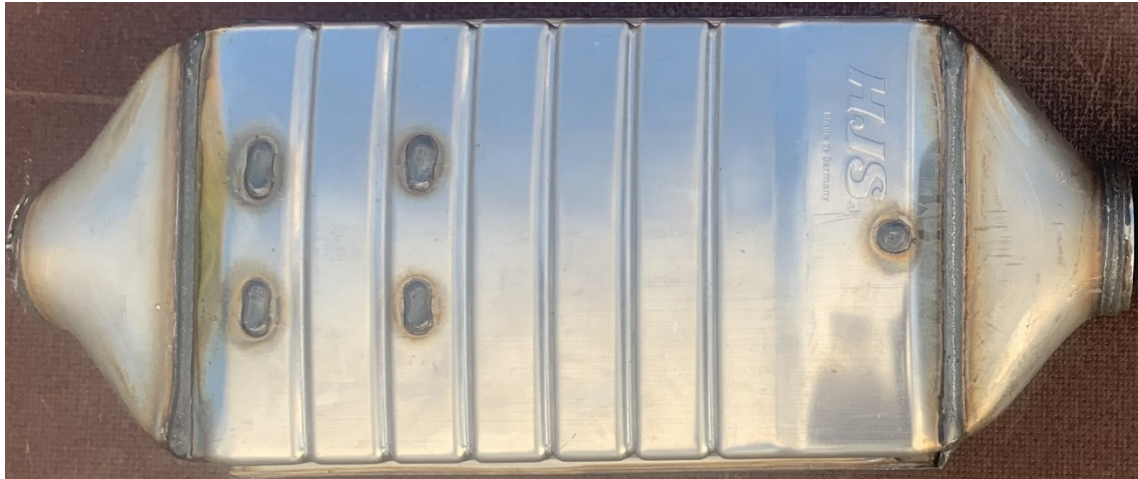
HJS partikelfilter DPF-05 til Mercedes. Flowretning fra venstre mod højre (se pil på filteret)
