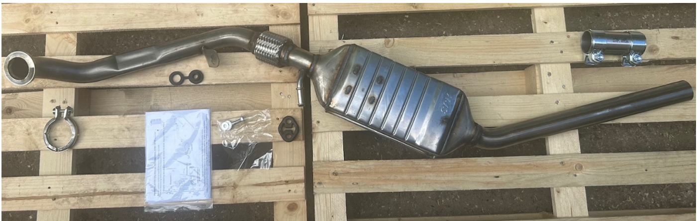
HJS partikelfilter DPF-05 til Mercedes. Flowretning fra venstre mod højre (se pil på filteret)
